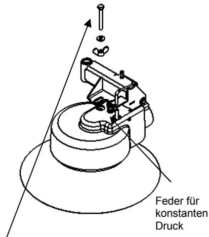
Flügelmutter und Innen-Sechskant Schraube M10 (Höhenverstellung des Seitenbesens)
