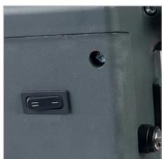
Auf der Rückseite des Handgriffs befindet sich der Umschaltknopf der zwei Geschwindigkeiten 180 und 500 1/min.
